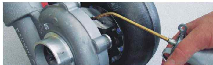
Aby nasmarować łożyska wału wirników, przed montażem należy wlać nieco oleju silnikowego.
