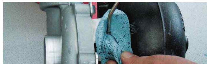
... używając sprężonego powietrza, rozprowadzić olej w łożyskach.
