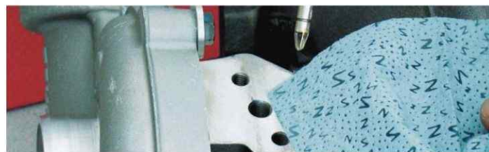
następnie przykryć otwór wlotowy oleju czystą szmatką i ...
